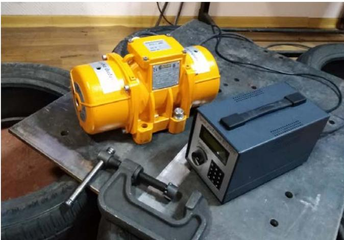
Комплекс позволяет проводить виброобработку крупногабаритных деталей на резонансной частоте. В результате происходит перераспределение внутренних напряжений, геометрия изделия выравнивается, концентраторы напряжений, как источники будущего разрушения металла, уходят. Виброобработка дает возможность избежать дорогостоящей термической обработки при схожих результатах.
