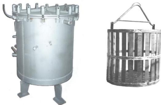
Предназначены для стерилизации пищевых продуктов, расфасованных в стеклянные и жестяные банки. Могут быть использованы на предприятиях консервной промышленности. Автоклав комплектуется корзинами, расположение корзины в автоклаве вертикальное, что значительно облегчает выгрузку стерилизованных банок. Также по желанию заказчика автоклав может дополнительно комплектоваться механизмом выгрузки.
