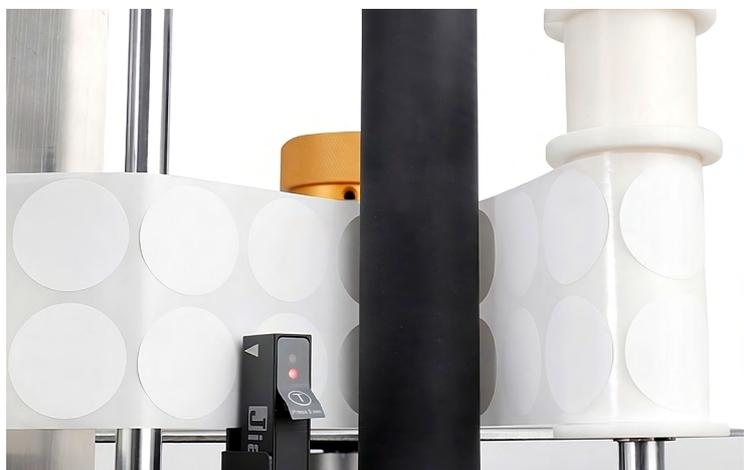
Настольный автоматический перемотчик этикеток со встроенным термоструйным принтером или без него. Компактная система для нанесения фиксированной или переменной информации (включая динамические Datamatrix коды) высотой до 25 мм на этикетки различного размера.
