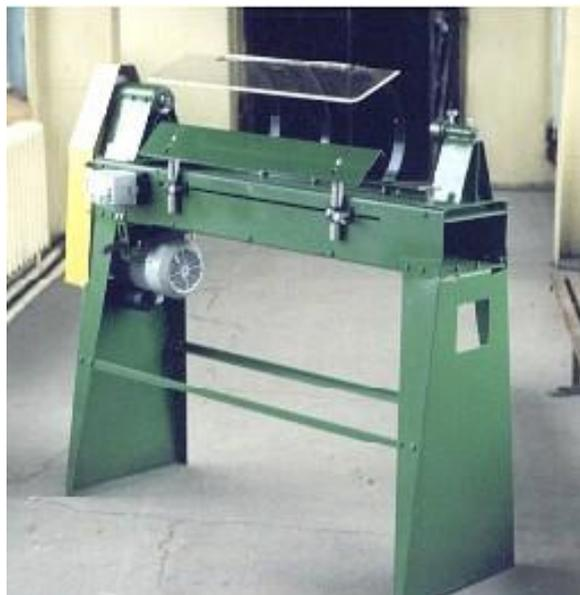
Токарный станок предназначен для выполнения токарных работ по различным породам дерева.
