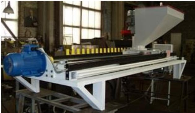
Делитель-укладчик конструктивно выполнен на базе тестоделителя "Кузбасс 68-2М" с вертикальным расположением шнека.
