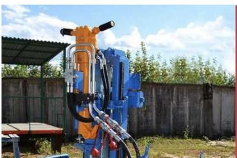
**Гидромолот** предназначен для погружения забивных грунтоносов диаметром до 121 мм при отборе образцов ненарушенной структуры для инженерных изысканий в строительстве.
