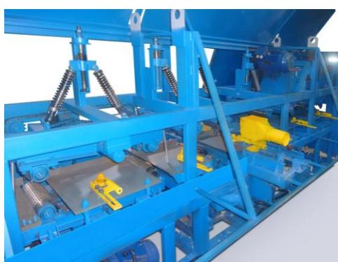
**Размер изделия** быстро регулируется по специальным линейкам (каждый из четырех шпинделей имеет независимую регулировку)
