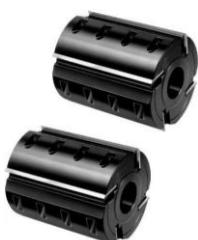
Поставляются в комплекте с ножами. Доступны в 4-ех ножевом и 6-ти ножевом исполнении. 6-ти ножевые барабаны дороже, но позволяют ощутимо повысить качество получаемой поверхности или скорость обработки (или у то и другое одновременно, но в меньшей степени). Два верхних и один нижний строгальные барабаны с ножами. Используются для обработки верхней и нижней плоскости изделия (4-ех ножевой барабан 36 600 руб. за шт., 6-ти ножевой барабан 48 900 руб. за шт.).
