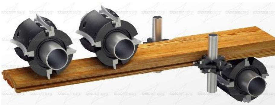
Обработка заготовки производится с четырех сторон за один проход. На выходе из станка получается готовое изделие - доска пола, вагонка, блок-хаус, плинтус и т. д.
