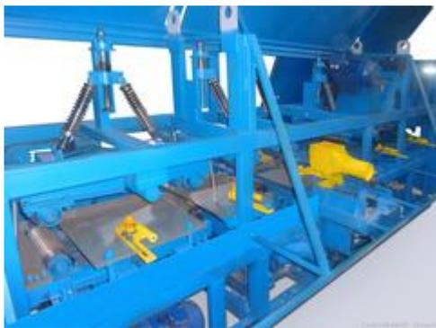
**Размер изделия** быстро регулируется по специальным линейкам (каждый из четырех шпинделей имеет независимую регулировку)
