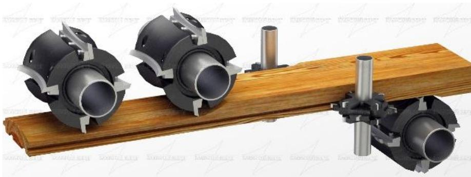
Обработка заготовки производится с четырех сторон за один проход. На выходе из станка получается готовое изделие - доска пола, вагонка, блок-хаус, плинтус и т. д.
