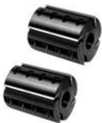
**Строгальные барабаны.** Используются для обработки верхней и нижней пласти изделия. Поставляются в комплекте с ножами. Доступны в 4-ех ножевом и 6-ти ножевом исполнении. 6-ти ножевые барабаны дороже, но позволяют ощутимо повысить качество получаемой поверхности или скорость обработки (или у то и другое одновременно, но в меньшей степени). Два верхних и один нижний строгальные барабаны с ножами. Используются для обработки верхней и нижней плоскости изделия (72 000 руб. (24 000 руб./шт.).
